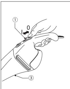
ON/OFFスイッチ(①)を“I”に合わせると電源が入ります。電源を切るにはON/OFFスイッチを“O”に合わせます。お掃除終了後には、ダストケース(③)にたまったゴミを捨てるよう心がけてください。またダストケース内部とフィルターの掃除もこまめに行ってください。
